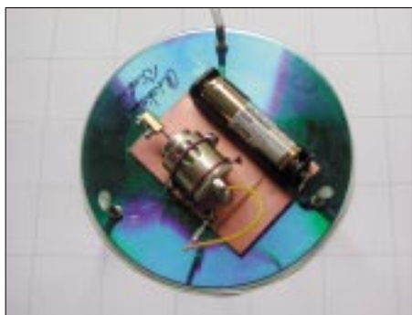
Die Kupferfläche der Grundplatine wird unsymmetrisch unterbrochen, damit die Teilflächen stets mit der Batterie verbunden bleiben können. Als Schalterersatz dient ein 1,3-mm-Stecker mit Steckschuh.
