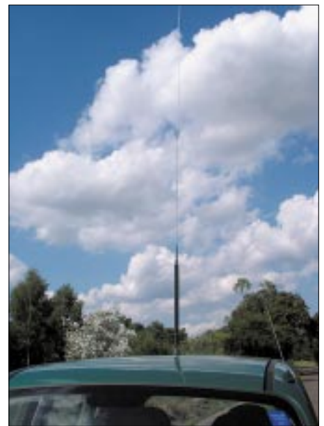
80-m-Antenne HFC-80L auf dem Dach eines Pkw. Deutlich sind Fußpunktspule mit Stabaufnahme sowie die Hülse zur Aufnahme des oberen Stabteils zu erkennen.
