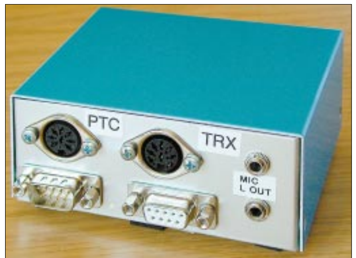
Bild 2: Rückseite der Umschaltbox von DH1NHM. Der linke Sub-D-Verbinder führt zum PTC-Controller, der rechte zum PC.
