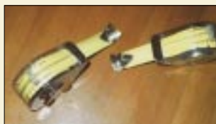
Aus zwei Maßbändern entsteht mit wenig Aufwand ein KW-Dipol
