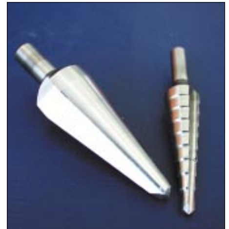
Bild 7: Schälbohrer zum Herstellen von sauberen Löchern in Dünoblechen
