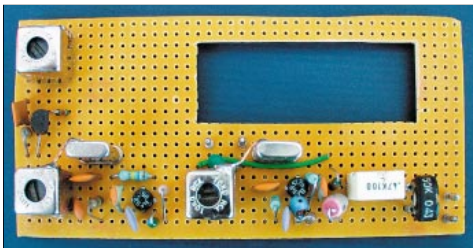
Bild 5: Aufbau der Schaltung auf einer Lochrasterplatine
