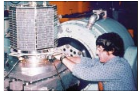
Projektleiter Jan King, W3GEY, montiert AO-7 für den Vibrationstest. Foto: AMSAT-NA
