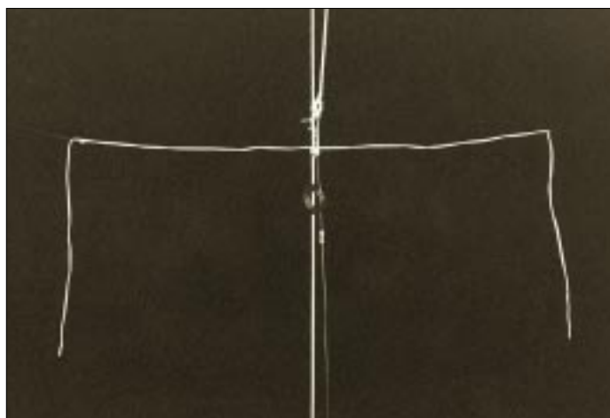
Bild 2 : Verlauf des Stehwellenverhältnisses in Abhängigkeit von der Frequenz. Abszisse: etwa 3 MHz/ Skalenteil Ordinate: s von 1 bis \infty
